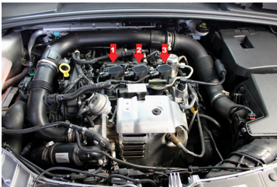
Abbildung 1: Motorraum Ford Focus 1.0 EcoBoost, Lage der Zündspulen
