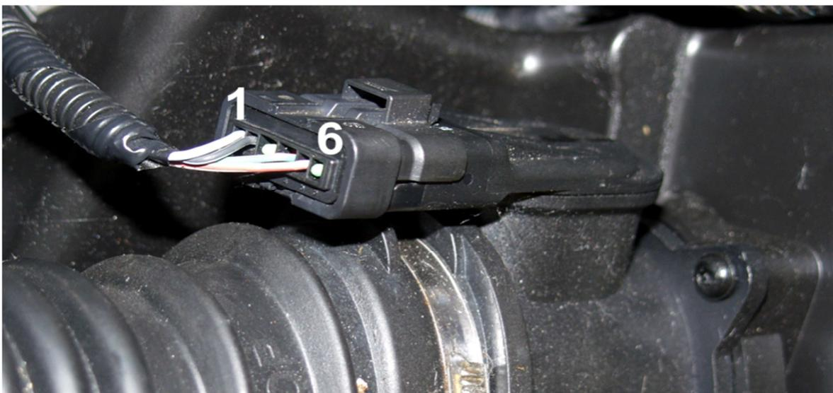
Figura 3: Ejemplo de la asignación de clavijas de un caudalímetro.
