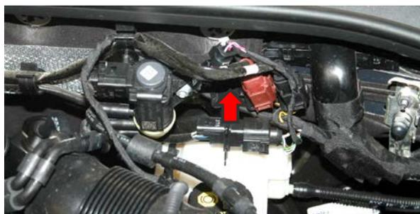
La sonda tiene 5 cables, y el mazo de cables del vehículo tiene 6.
