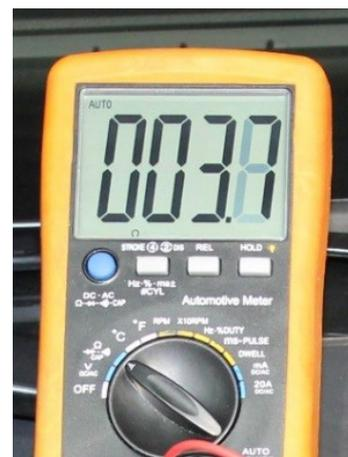
Resistencia del circuito calentador
