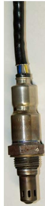
*Identificación de una sonda lambda de banda*
