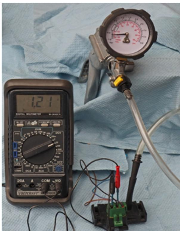
*Imagen 2: Medición de la tensión de la señal en un sensor de presión de colector de admisión de un motor de gasolina atmosférico. En un vacío de -0,6 bar (absoluta de 0,4 bar), la tensión de la señal es 1,21 V*
