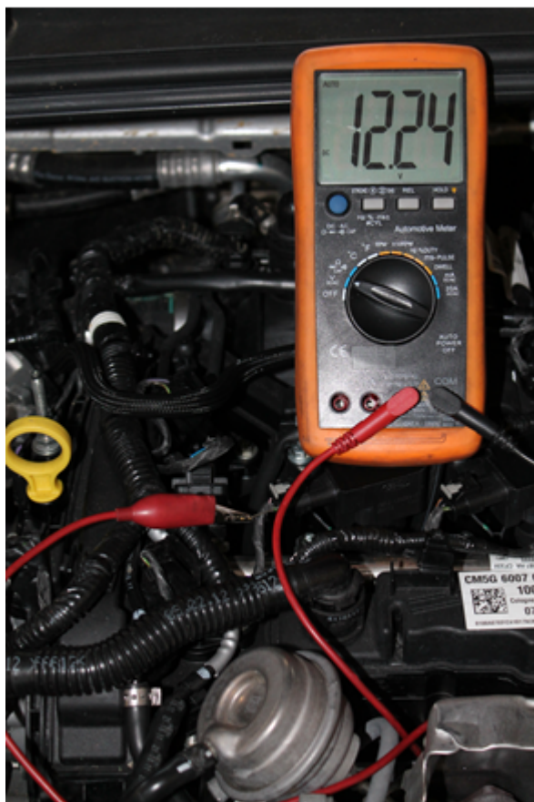
Εικόνα 5: Πηνίο ανάφλεξης 12.24V Ηλεκτρική τροφοδοσία
