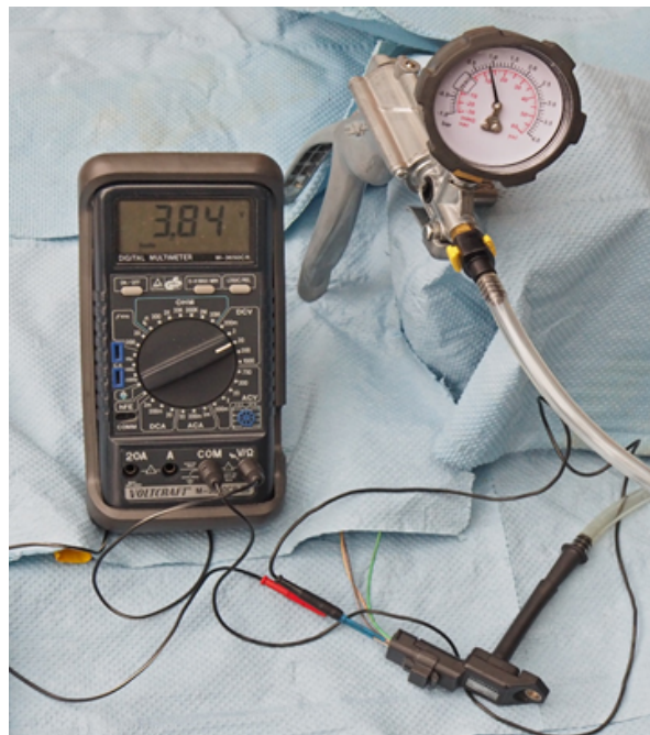
3 kép Tűrbómotor feltöltőnyomás jelfeszültségének mérése 0,9 bar túlnyomás esetén (abszolút érték: 1,9 bar). A jelfeszültség 3,48 Volt
