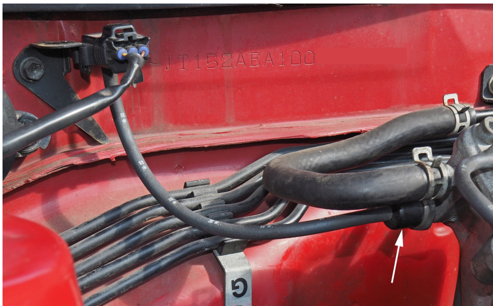
1. kép Benzinmotor szívócsövének nyomásérzékelője A nyíl a pneumatikus fojtószelepre mutat
