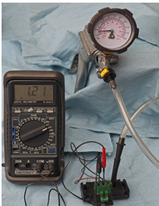
2 kép Jelfeszültség mérése egy turbótöltés nélküli benzinmotor szívócső nyomásérzékelőjén. -0,6 bar vákuum esetén (vagyis 0.4 bar abszolút értékű vákuum esetén) a jelfeszültség 1,21 Volt
