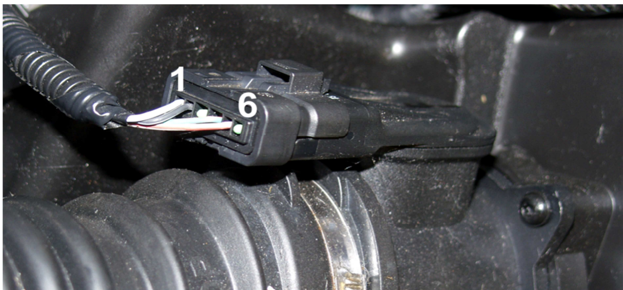
Afbeelding 3: Voorbeeld van een contact toewijzing van een LMM. Pin1: Signaal van de temperatuursensor inlaatlucht Pin 2: Aarde Pin 4: Voeding, +12 V Pin 5: Signaal LMM
