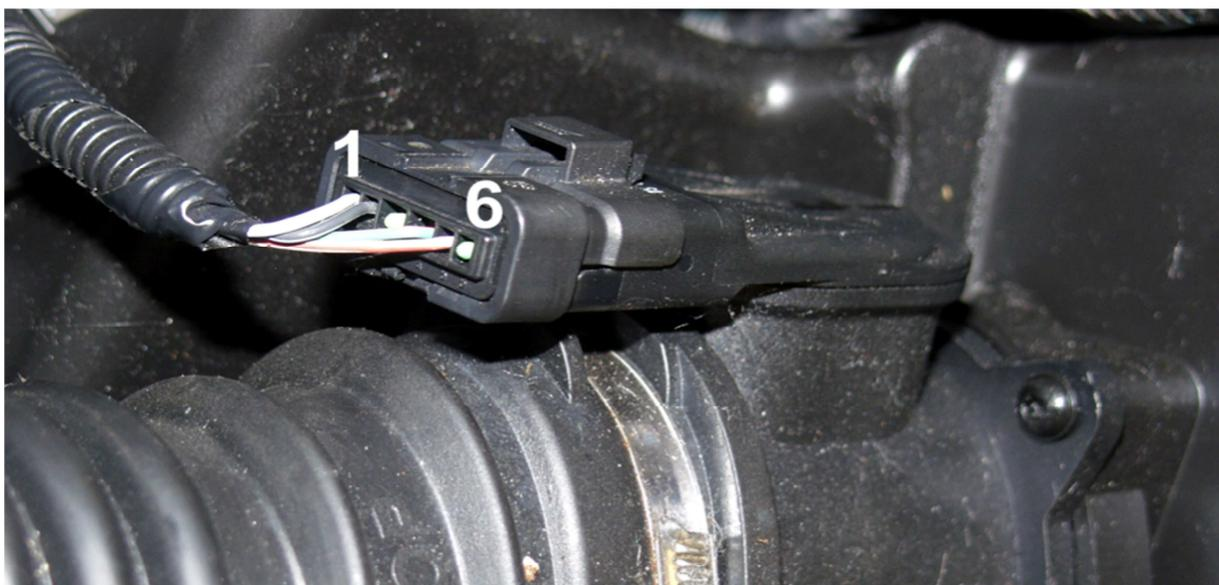
*Figura 3: Exemplo da afetação do pino de um medidor da massa de ar.
