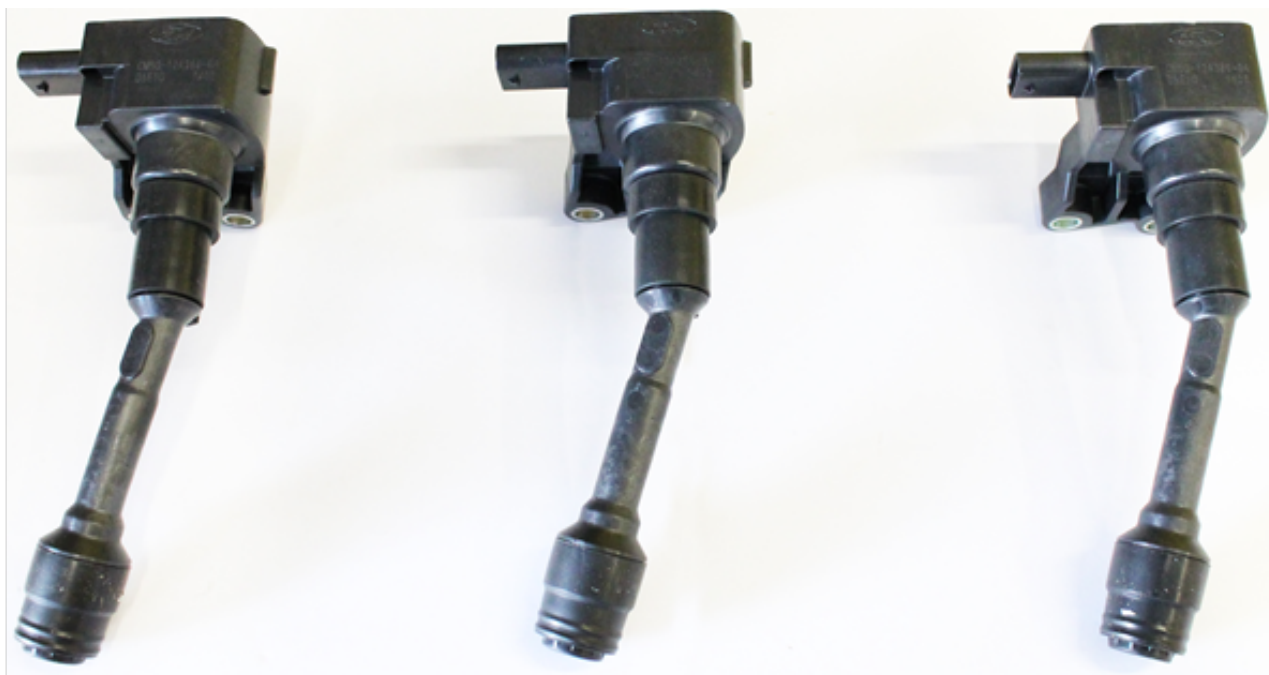
Imagem 2: Pormenor das bobinas de ignição
