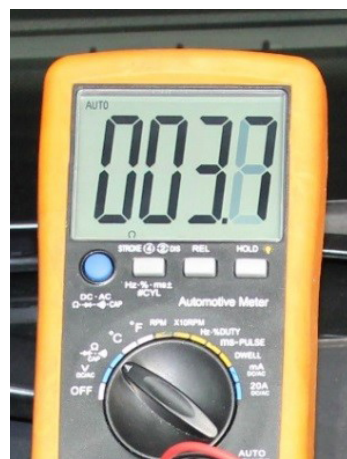
Rezistență a circuitului de încălzire
