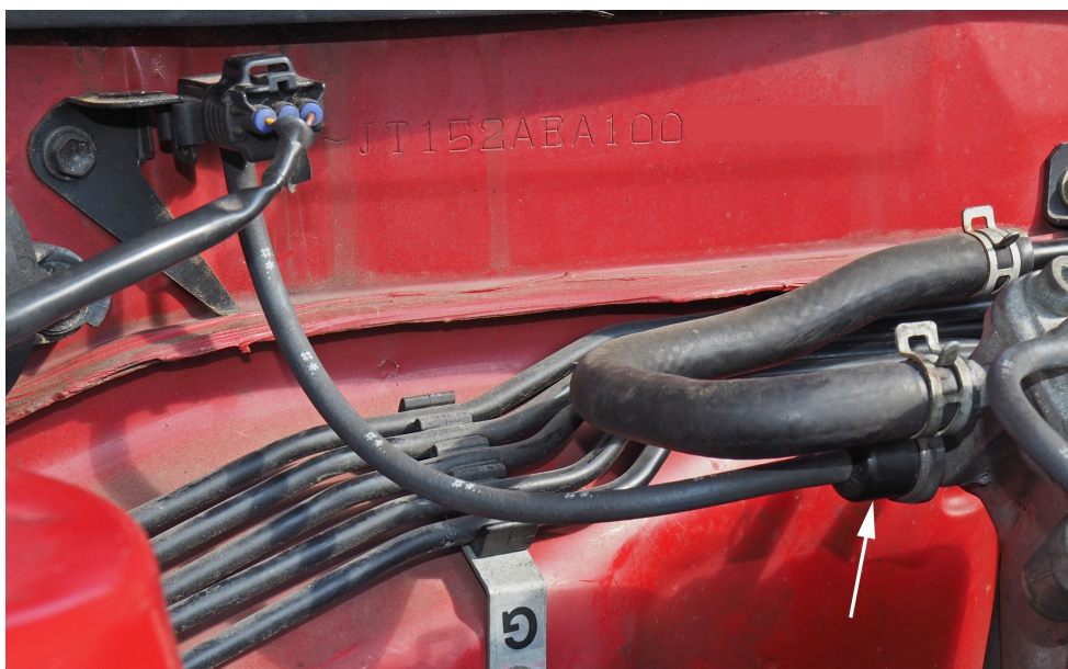
Imaginea 1: Senzorul de presiune al galeriei de admisie pentru un motor pe benzină. Săgeata indică accelerația pneumatică
