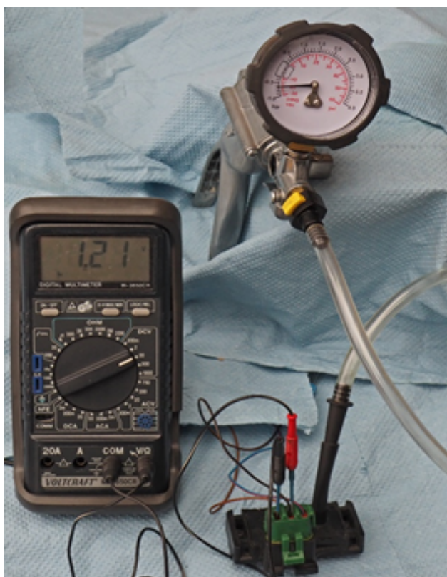
Imaginea 2: Măsurarea tensiunii de semnal la un senzor de presiune al galeriei de admisie a unui motor pe benzină fără supraîncărcare. La un vid de -0,6 bari (absolut 0,4 bari), tensiunea de semnal este de 1,21 V
