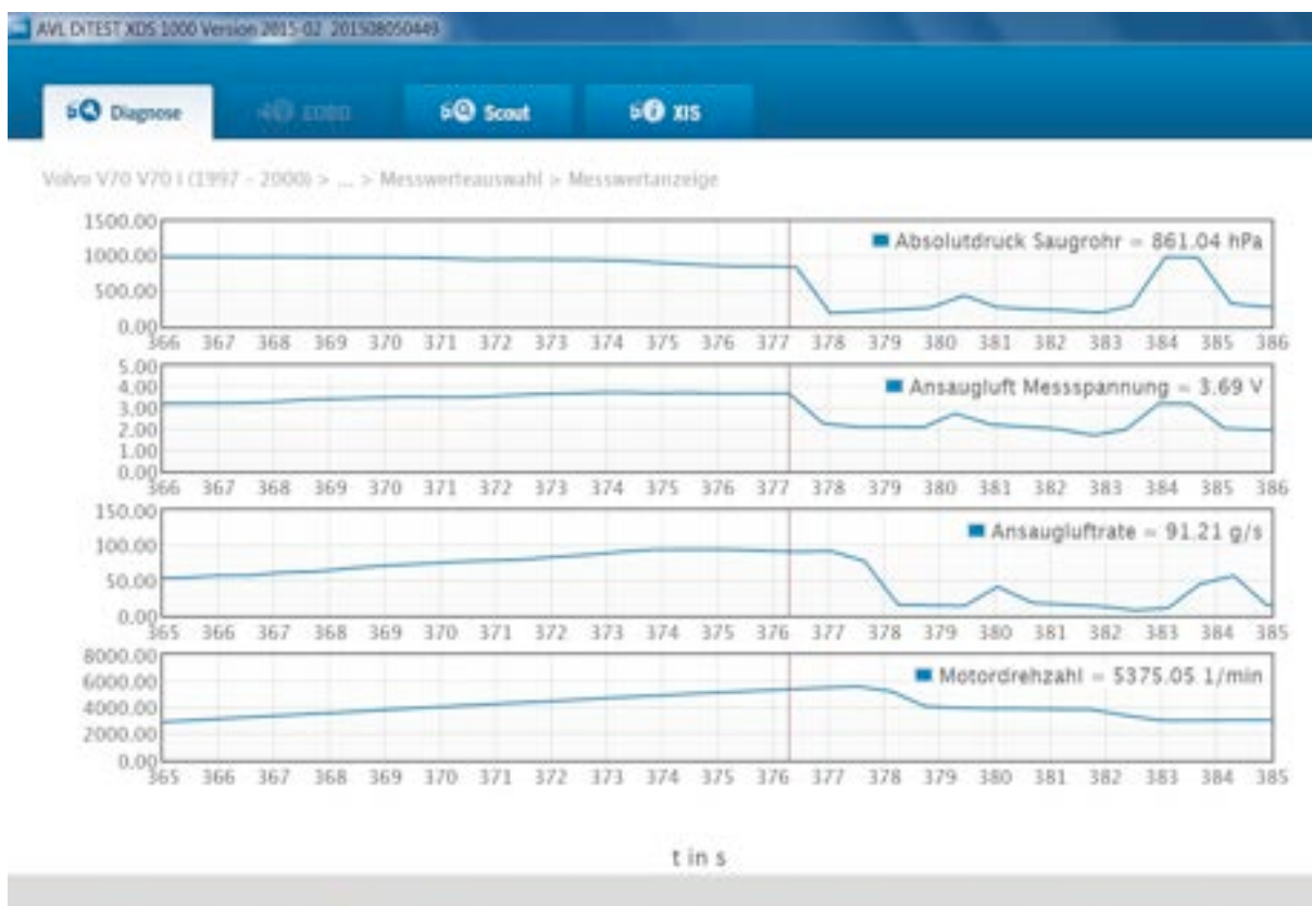
Рисунок 10: Двигатель на Рис. 9 после неудачной попытки очистки расходомера воздуха. Несмотря на увеличение значения количества воздуха от 44 г/сек до 91 г/сек, установочное значение в 125 г/сек не достигается, что подтверждается низким напряжением сигнала в 3,7 В.
