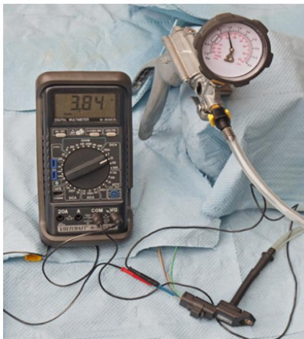
Изображение 3: Измерение сигнального напряжения на датчике давления наддува турбированного двигателя при избытке давления 0,9 бар (абсолютное 1,9 бар). Сигнальное напряжение составляет 3,84 В
