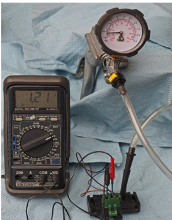
Изображение 2: Измерение сигнального напряжения на датчике давления впускного коллектора бензинового двигателя без турбонаддува. При давлении вакуума -0,6 бар (абсолютное 0,4 бар) сигнальное напряжение составит 1,21 В
