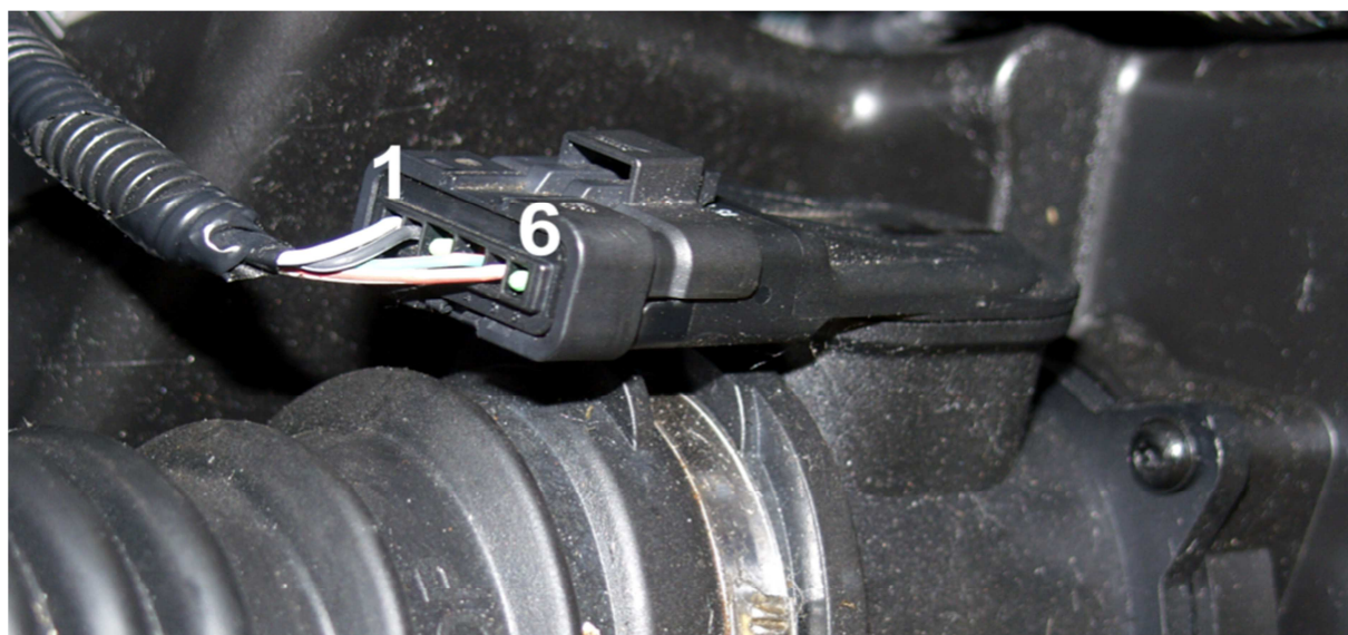
Slika 3: Senzorski element merača količine vazduha. Priključak 1: Signal senzora temperature Usisni vazduh Priključak 2: Uzemljenje Priključak 4: Napajanje, +12V Priključak 5: Signal protoka vazduha
