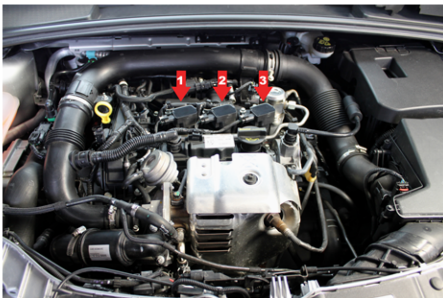
Slika 1: Prostor Ford Focus 1.0 EcoBoost motora. Lokacija namotaja za paljenje
