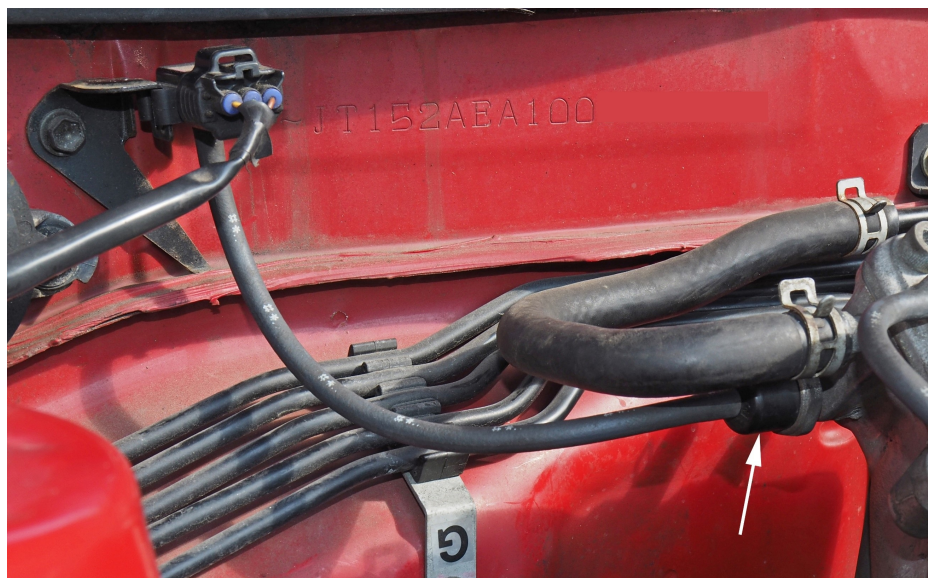
Зображення 1: Датчик тиску впускного колектора дизельного двигуна. Стрілка вказує на пневматичний регулятор подачі палива
