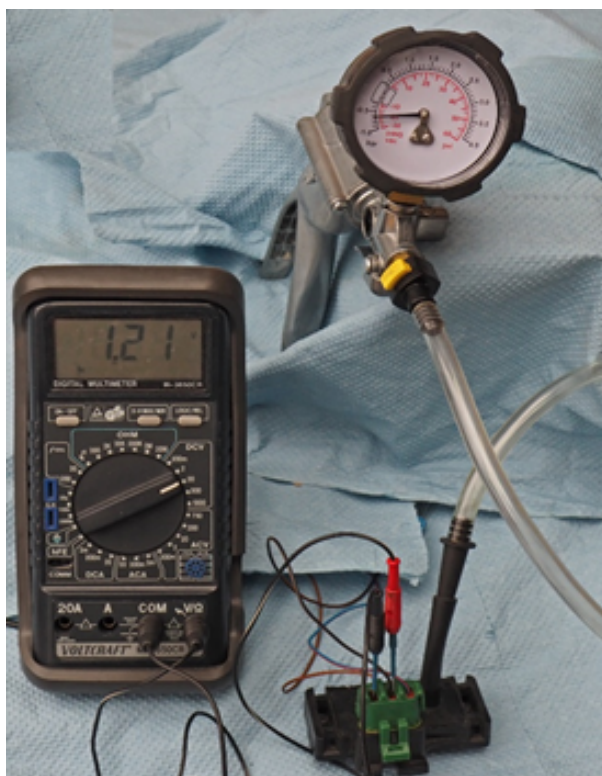
Зображення 2: Вимірювання сигнальної напруги на датчику вхідного повітря колектора дизельного двигуна без турбонагнітання. При вакуумі у -0,6 бар (абсолютне значення 0,4 бар) сигнальна напруга становить 1,21 В
