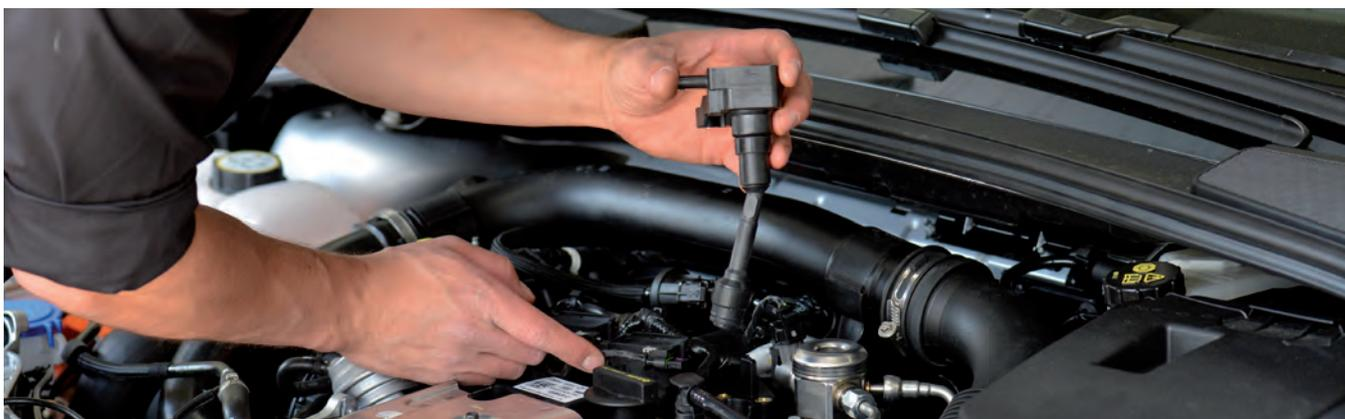
Como tantos outros componentes, a bobina de ignição também se encontra sujeita a um certo desgaste. A sua vida útil é de geralmente entre 60.000 e 80.000 quilómetros, mas existem diversos fatores que podem afetar a sua longevidade.
