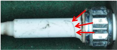
(zerlegte Zündkerze – Gewinde entfernt) Bruch im Isolator
